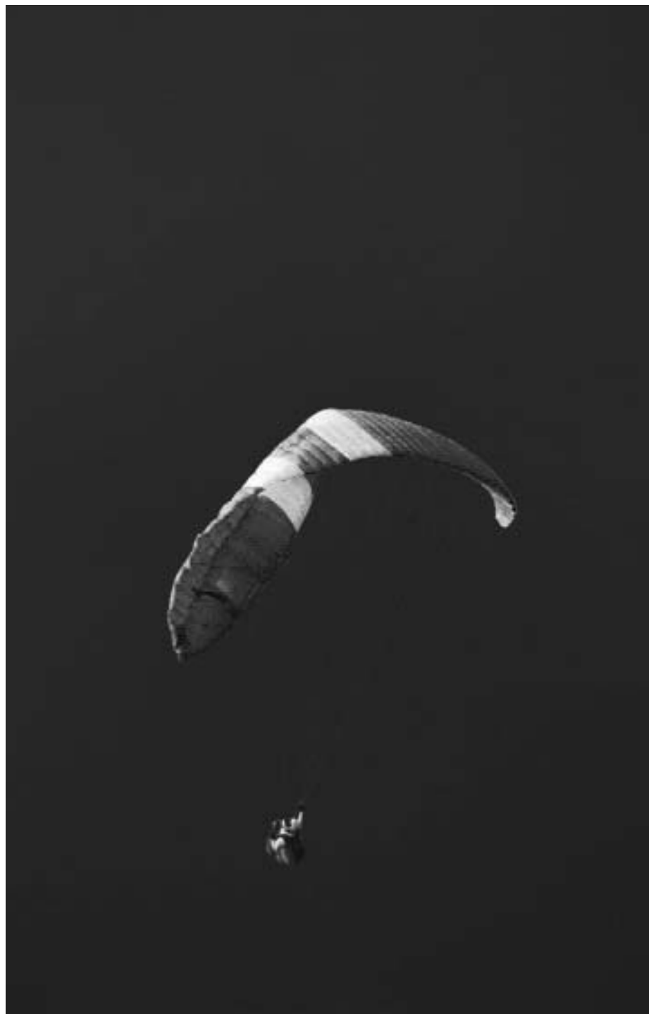
Nácvik figur lze vyzkoušet na některém z kursů zvláštních letových režimů nad vodní hladinou. Dobrovolným stržením jednoho A-popruhu můžeme docílit i více než 50% zaklopení vrchlíku a lze tak vyzkoušet jeho reakci po zaklopení.
